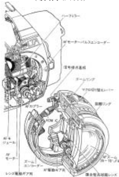
図 11 一眼レフカメラの自動焦点機構 (ミノルタ \alpha -7000)
