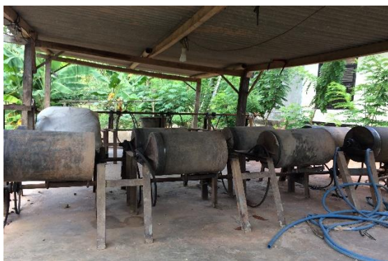
図 2 Milling input 7.5cc Mercury
